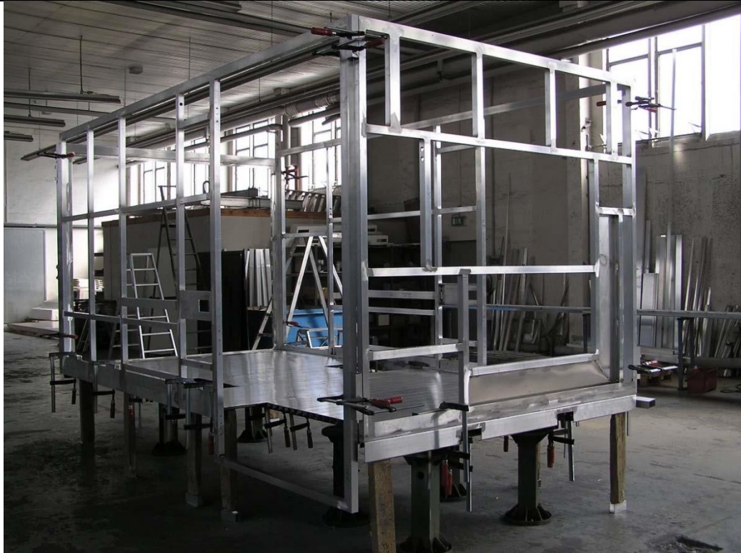
Ossature de notre système de caisson amovible
