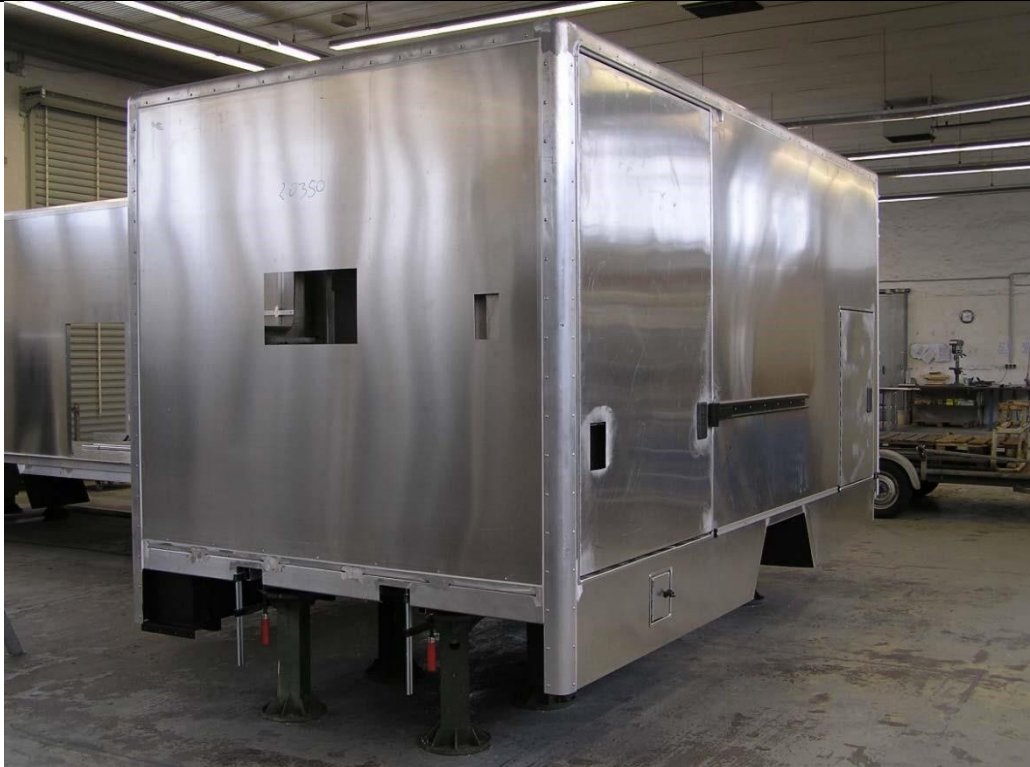
Caisson brut prêt à être peint / exemple avec porte coulissante supplémentaire à gauche
