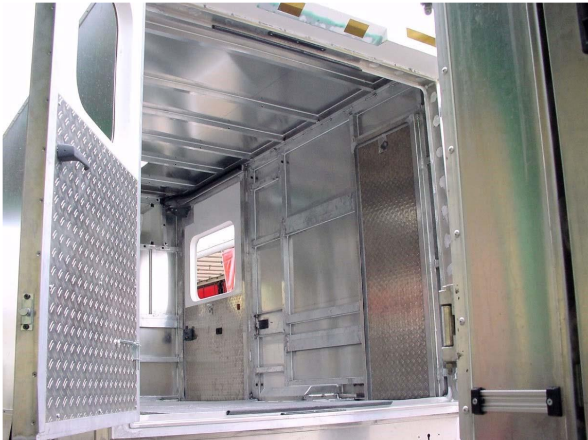
Vue intérieure de l'arrière. Les longerons et nervures soudés formant l'ossature du caisson sont bien visibles. La structure est composée à 100% d'aluminium. Aucun autre matériau n'est utilisé ici.
