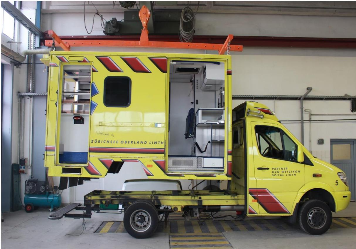
Le caisson de l'ambulance est complètement démonté. Il est suspendu à la grue avec ses quelque 1600 kg.
