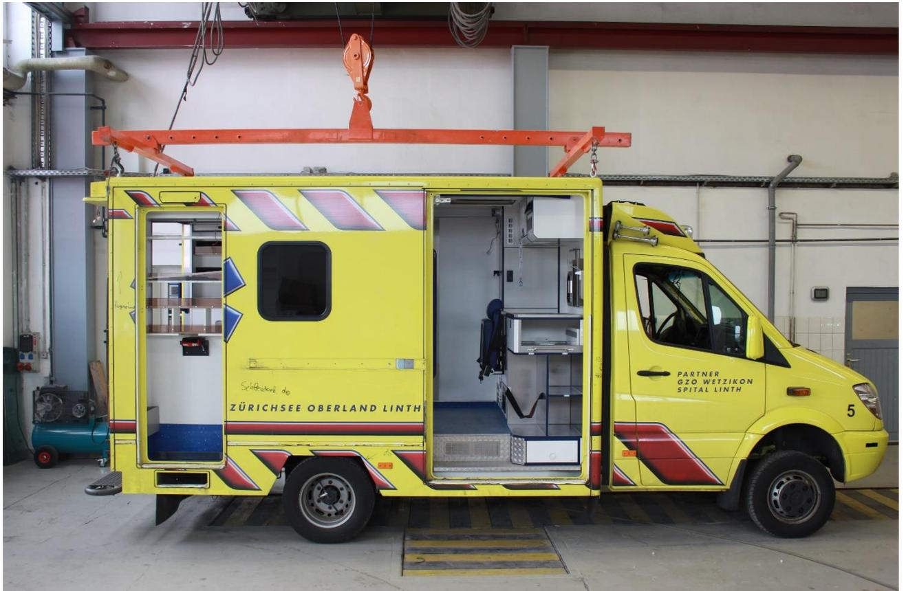
Le caisson est séparé mécaniquement du châssis-cabine au moyen d'un engin de levage approprié.
