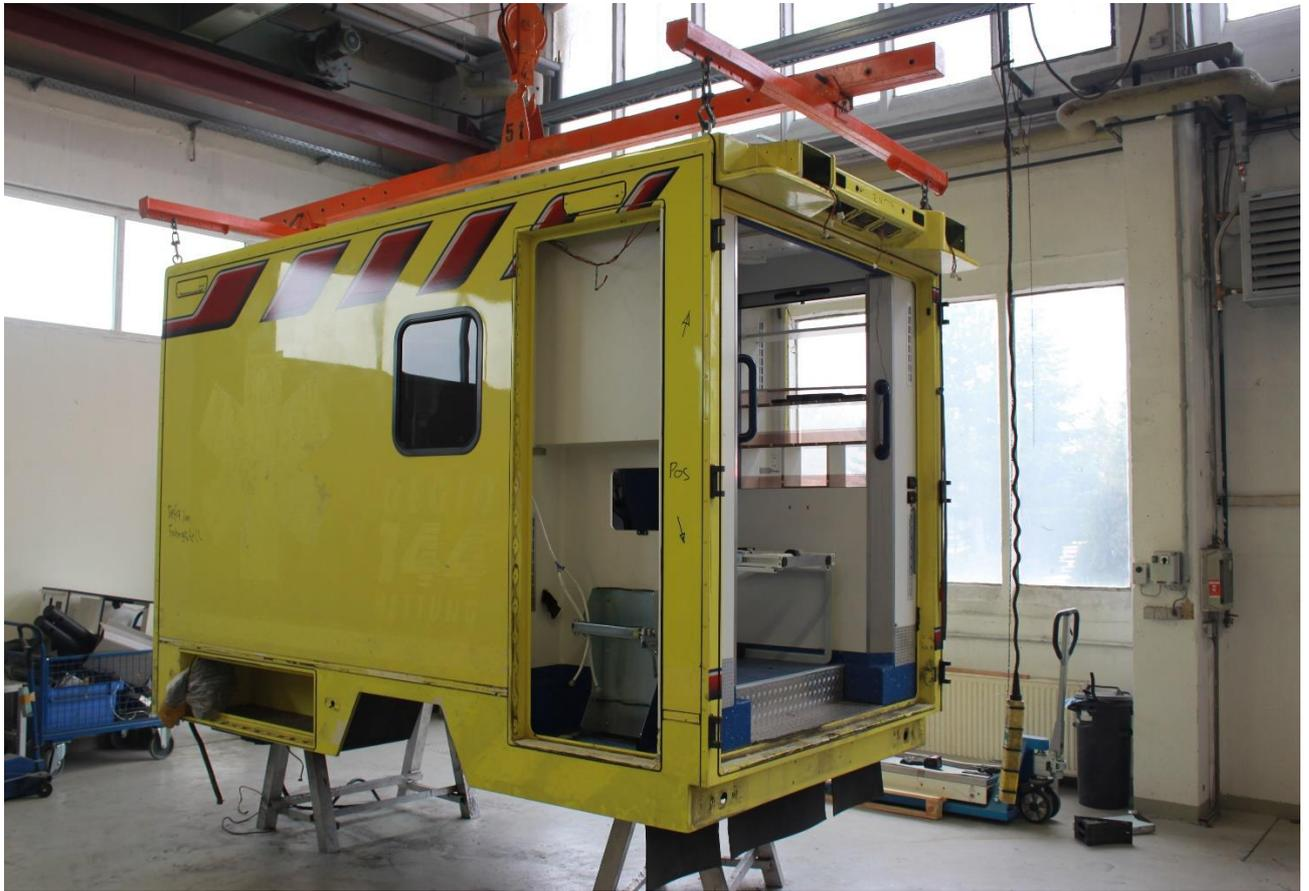
On procède alors aux transformations nécessaires pour adapter le caisson au nouveau châssis.
