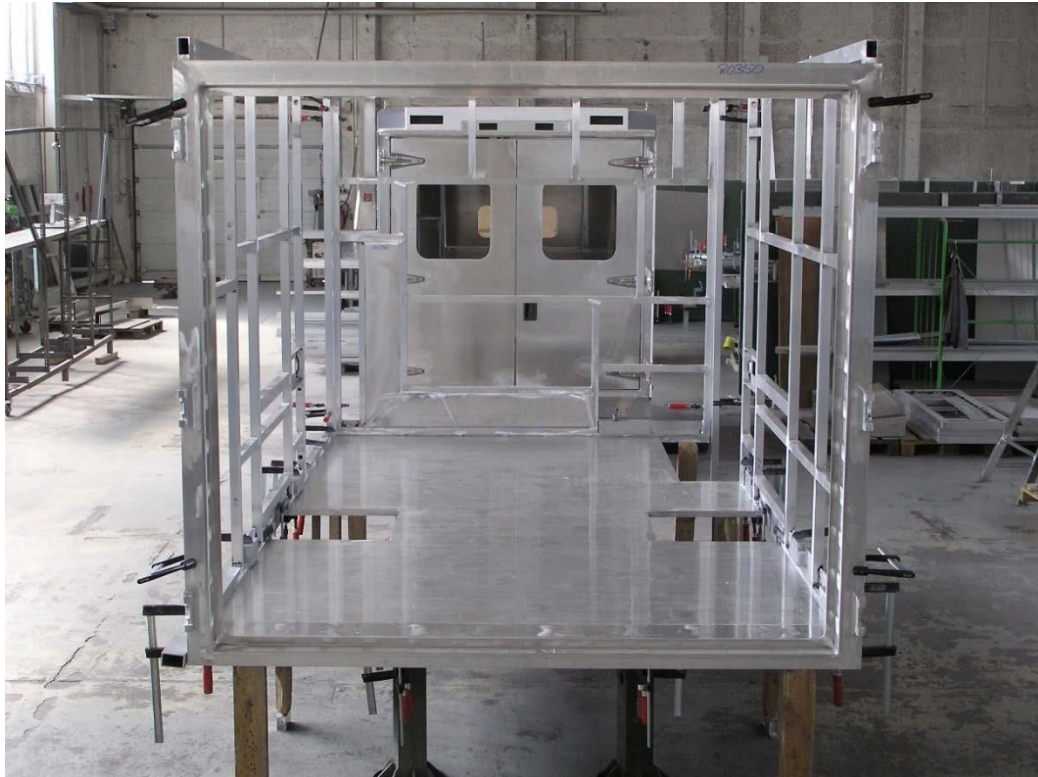
(Heckansicht mit Vorbereitung Heckportaleinsatz)
