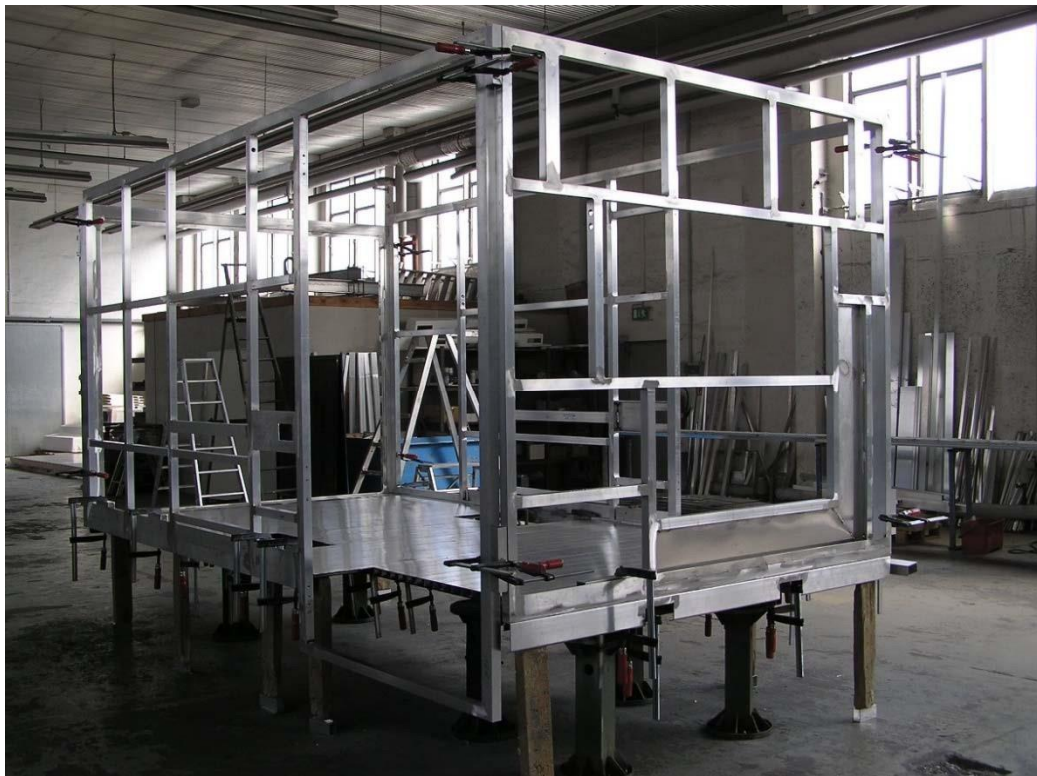
(Die typische Gerippe-Bauweise unseres Wechselkoffersystems)
